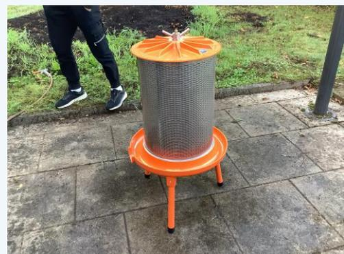
Äpfel in die Obstmühle gemacht, dort werden die Äpfel durch ganz viele kleine Messer die zerschnittenen. Anschließend kommen die Äpfel dann in die Apfelpresse wo sie zu Apfelsaft gepresst werden.
